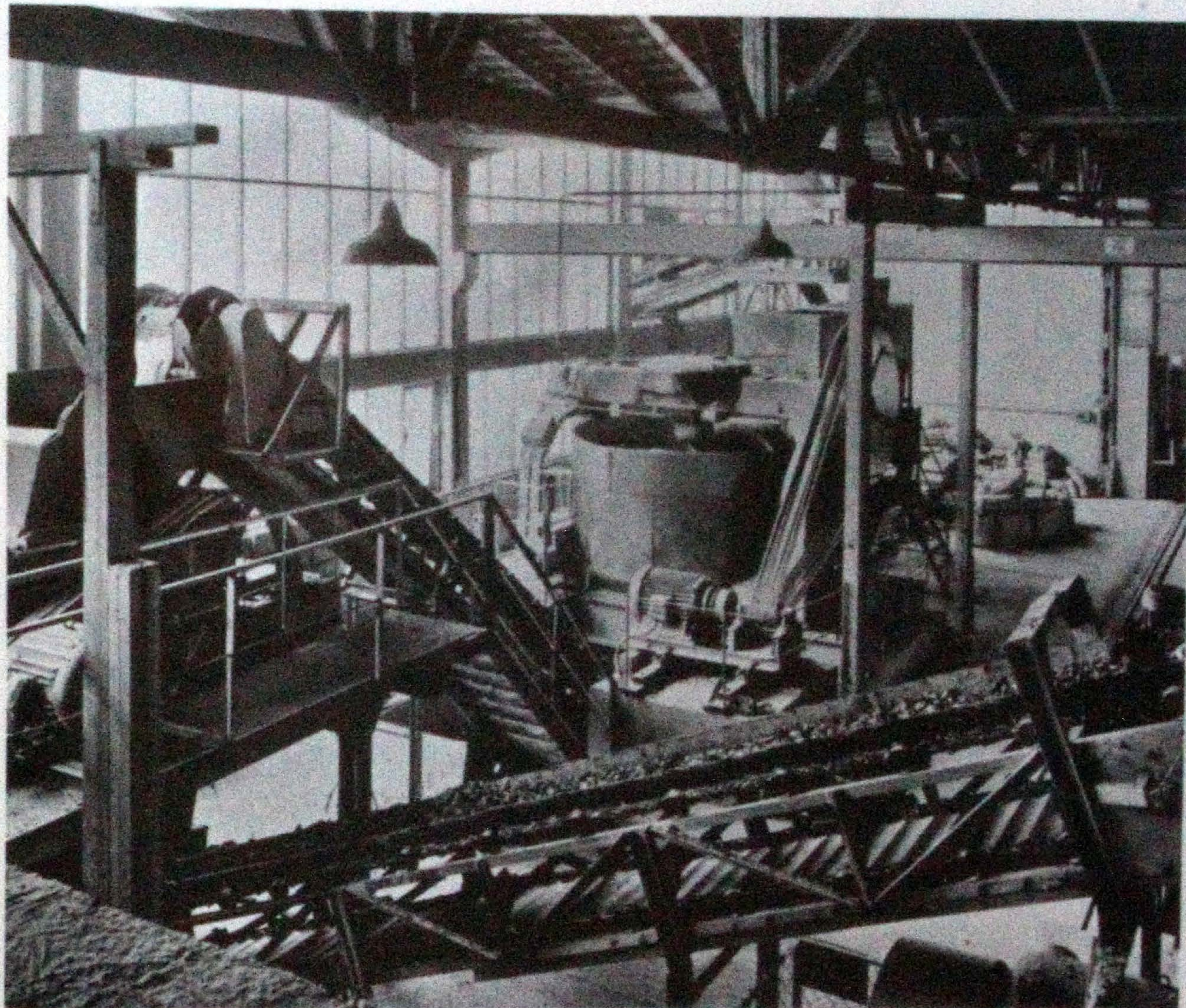
Aufbereitungsanlage des Werkes Göllersdorf. Der Ton wird in Aufbereitungsmaschinen zerkleinert und durchgeknetet.
